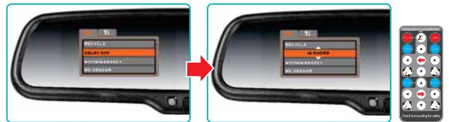
**Установка чувствительности функции распознавания движения, в сочетании с задержкой выключения видеозаписи.**
